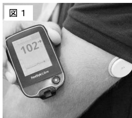
図1 フリースタイルリブレを装着したところ。装着感はなく、装着、脱着時の痛みも無い。血管内ではなく、間質液の血糖値を2週間連続測定する。
